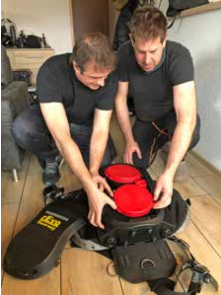
Öffnet man die Abdeckung, sieht man zunächst die beiden Kalkpatronen, die vom Taucher selbst befüllt werden können.
