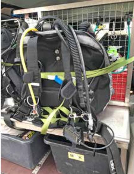
Fertig montiert zum Tauchen. Ohne Flasche und Kalk wiegt das Gerät nur knapp 14 Kilo und kann damit auch ohne Weiteres im Flugzeug transportiert werden.
